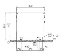
Electrical inlet (power) Equipotential screw
